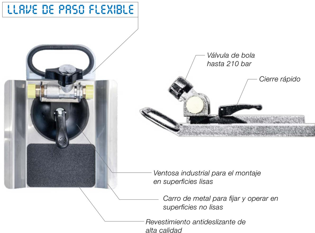
Como alternativa a un control remoto que corta la alimentación de su bomba de alta presión, la llave de agua le permite cortar el suministro de agua para detener la rotación del cepillo. Esta es una válvula de bola de alta presión montada en una ventosa con corredera metálica.
