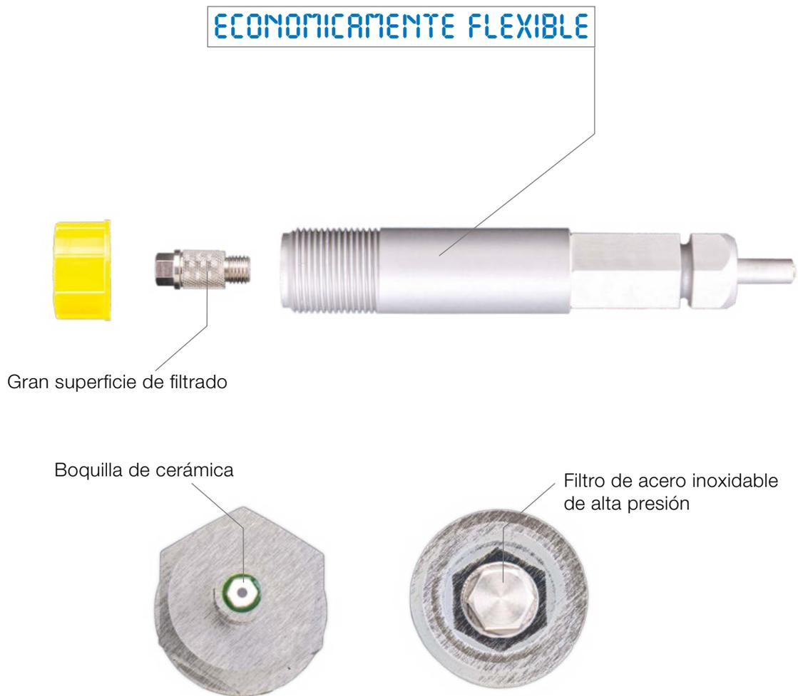
En todos los SOLA-TECS C utilizamos una boquilla de 9 l/min como tamaño estándar. Esto supone un caudal de agua de 9 litros por minuto a una presión de agua de 100 bares.
